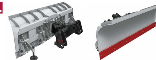
Антишок – защита отвала; при наезде на препятствие, режущая кромка откидывается (за счет пружинной системы), а после проезда неровности возвращается в первоначальное положение. Поворот отвала – гидравлический или механический, максимальный угол – 23° градуса. Отвал также имеет систему регулирования бокового уклона.
